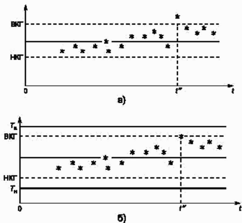
$T_n, T_n$  — нижнее и верхнее предельные значения поля допуска;
