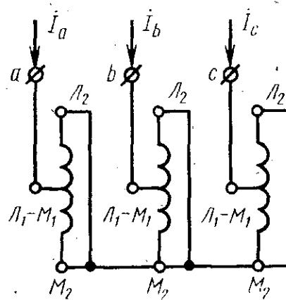
Зажимы фаз однофазного реактора:  $A$ ,  $X$ ,  $B$ ,  $Y$ ,  $C$ ,  $Z$  или  $L_1$ ,  $L_2$ ; зажимы фазы сдвоенного реактора:  $L_1-M_1$ ,  $L_2$ ,  $M_2$ ; зажимы источника практически синусоидального напряжения номинальной частоты; однофазного —  $a$ ,  $x$ ; трехфазного —  $a$ ,  $b$ ,  $c$ .
