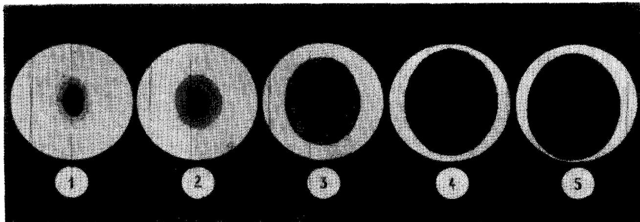
Если внешний вид фильтра не соответствует какому-либо баллу, а находится между близлежащими баллами, то результаты испытания оценивают промежуточным баллом.
