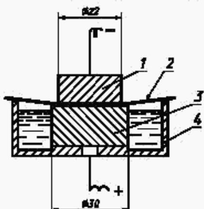
Электролитическая ячейка (см. чертеж) состоит из двух медных электродов с плоскими параллельными друг другу поверхностями. К электродам прикладывается постоянное напряжение в 1,2 В.
