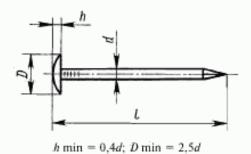
Условное обозначение обойных гвоздей с диаметром стержня 2,0 мм и длиной 20 мм:
