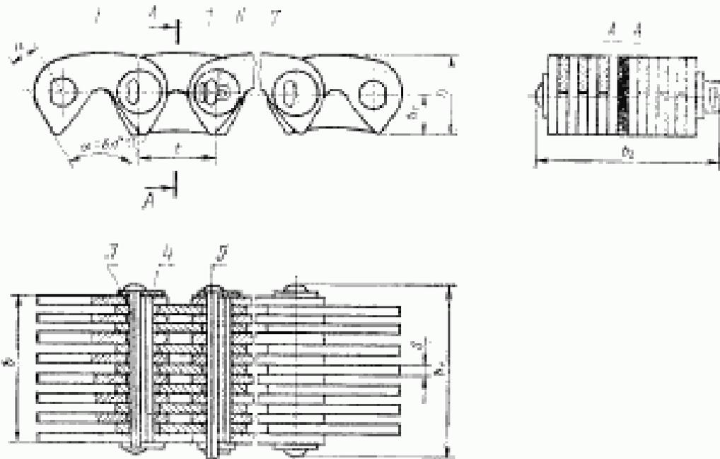
1—рабочая пластина; 2—направляющая пластина; 3—удлиненная призма; 4—внутренняя призма; 5—соединительная призма; 6—шайба; 7—шплинт
