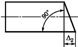
Косину реза ( $\Delta_2$ ) измеряют металлическим угольником по ГОСТ 3749—77, лежащим одной стороной на плоскости расположения слитка, и измерительной линейкой по ГОСТ 427—75. Измерение косинуса реза проводят на двух торцовых плоскостях.
