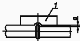
Т а б л и ц а 7 — Смещение кромок стыкуемых труб
