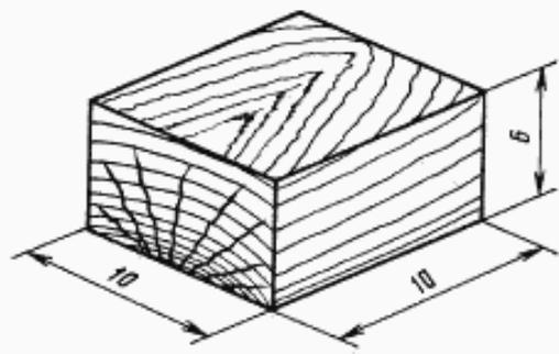
3.6. Образцы древесины для испытания должны иметь размеры 10 × 10 × 6 мм (см. чертеж).
