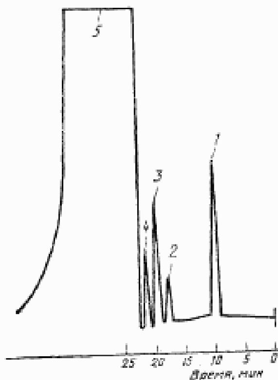
1 — метанол, 2 — акролен, 3 — ацетон, 4 — ацетонитрил, 5 — акрилонитрил.
