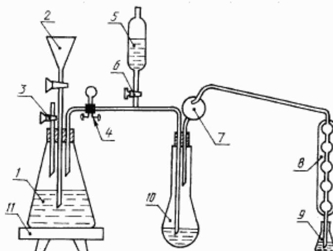
1 — бачок-парообразователь (или колба из термостойкого стекла вместимостью 2000 см<sup>3</sup>); 2 — воронка; 3 — кран; 4 — зажим; 5 — воронка для гидрокиси; 6 — кран; 7 — каплеуловитель; 8 — холодильник; 9 — коническая колба вместимостью 250 см<sup>3</sup>; 10 — колба Кьельдаля; 11 — плитка электрическая
