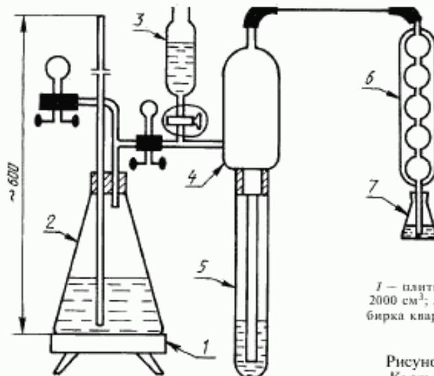
1 — плита электрическая; 2 — колба коническая вместимостью 2000 см<sup>3</sup>; 3 — воронка делительная; 4 — каплеуловитель; 5 — пробирка кварцевая; 6 — холодильник; 7 — колба коническая вместимостью 250 см<sup>3</sup>
