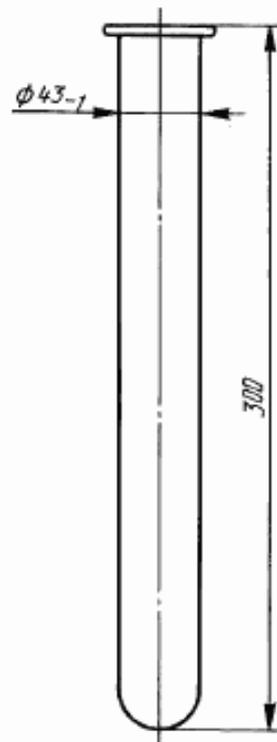
Рисунок А.4 — Пробирка из стекла ТС
