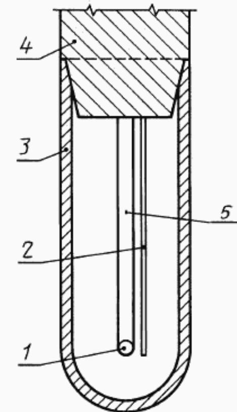
1 — шарик термистора; 2 — проволока для помешивания; 3 — пробирка для пробы; 4 — оправка; 5 — стеклянный зонд
