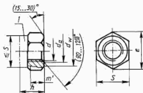
1 — стопорящий элемент (допускаются различные варианты исполнения)
