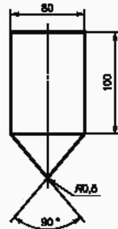
Рисунок 6 — Испытательный конус
