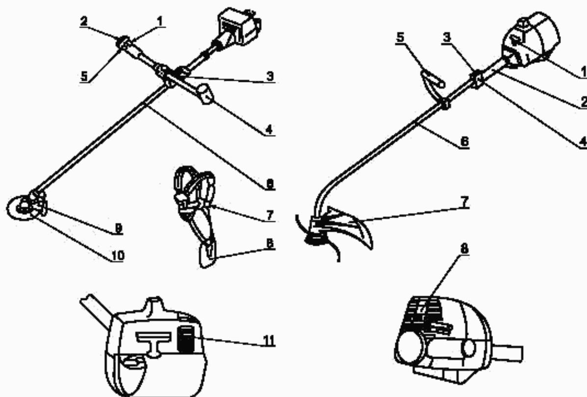
1 — устройство остановки двигателя; 2 — выключатель рычага дросселя; 3 — место подвески; 4 — рукоятка; 5 — штанга; 6 — механизм быстрого размыкания (система подвески); 7 — защитное устройство (система подвески); 8 — защитное устройство режущего приспособления; 9 — полотно; 10 — глушитель звука; 11 — рычаг воздушной заслонки
