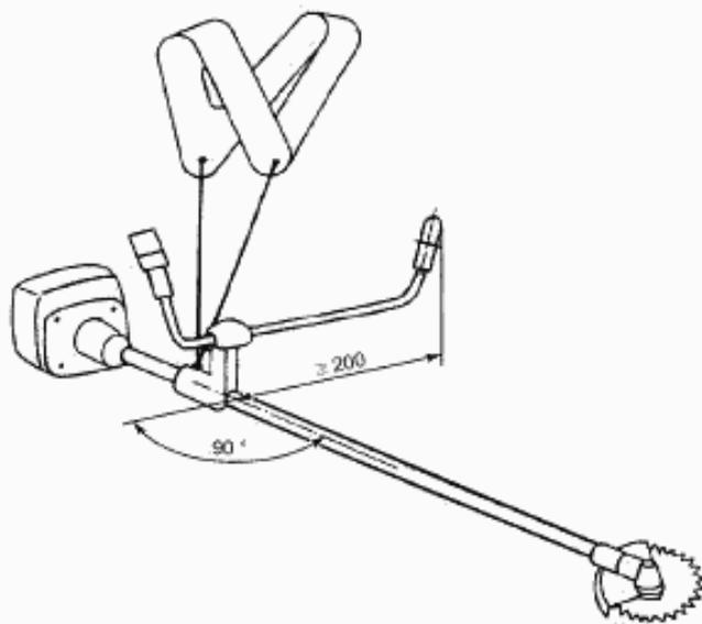
Рисунок 4 — Кусторез, ручка которого служит защитным устройством
